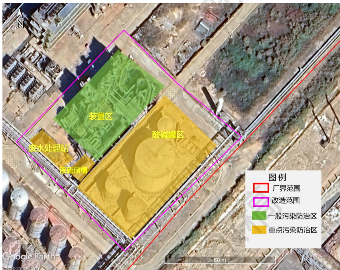
图 8.5-1 本次改造项目地下水防渗分区图
